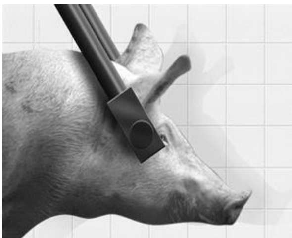
Figura 9 Posición de los electrodos para cerdos Figura 10 Posición alternativa de los electrodos para cerdos
