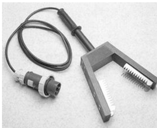
Figura 6 Tenazas de aturdimiento de tipo tenedor
