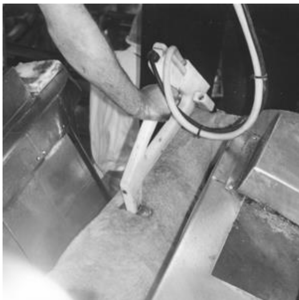
Figura 14 Posición correcta del electrodo posterior
