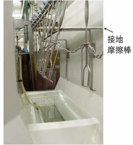
图22. 使用两根接地摩擦棒，保持与铁链持续的物理接触。图：Paul Berry 技术公司
