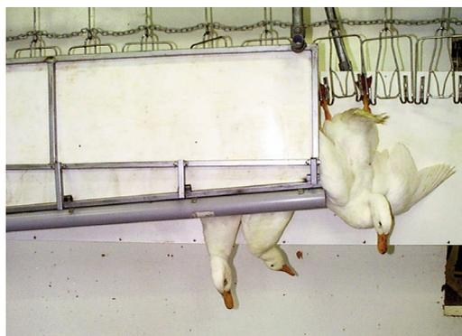
颈部扩展器应谨慎规划和安装，以防挡住视线，无法对致晕的即时性以及致晕前电击的发生情况进行评估。颈部扩展器完成安装后，应进行监控，以确保所有家禽头部均推至颈部扩展器下方（而非夹在上方，从而可能导致家禽翅膀或胸部发生致晕前电击和电麻痹。）
