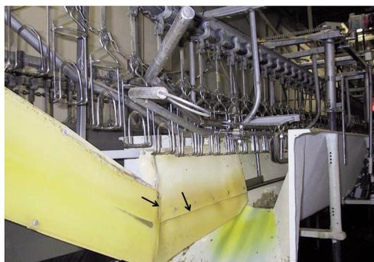
**图3b.** 如图所示，胸部接触片应延伸至水浴入口处。接触片应由单片材料制成，不得接合，以免家禽通过时受到干扰。上图显示有两处接合点（如箭头所示），接合点并不平坦，应换上单片材料。
