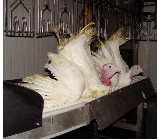
**图4.胸部支撑传送带上的肉鸡和火鸡。**传送带与脚铐线一起以相同的速度前进。每只家禽拷上脚铐并妥善地伏在传送带上后，脚铐操作人员应将家禽的翅膀折叠成自然合上的姿势，以降低其发生致晕前电击的风险。
