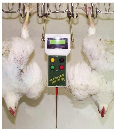
**图26. 电晕机评估设备。**该设备测量流经活禽的实际参数
