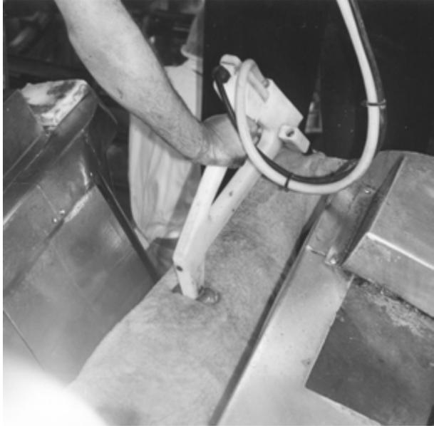
**Figura 14** Posición correcta del electrodo posterior
